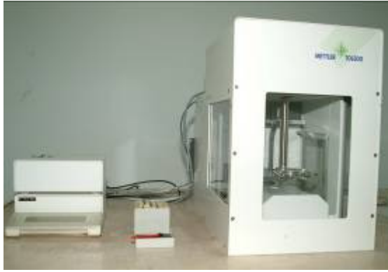
ميزان مقارنة على الدقة يستخدم فى المقام الأول لمعايرة الصنج كتلة ١ كجم بالمقارنة بالكيلو جرام البلاتينى الوطنى المصرى
