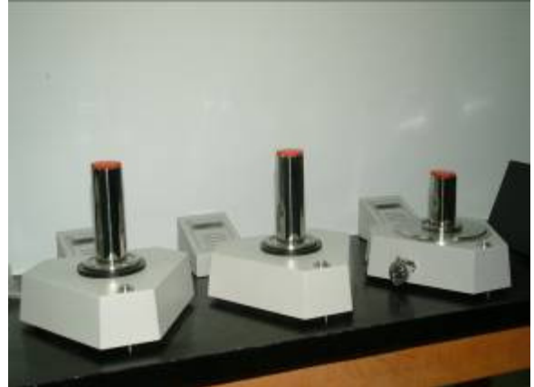
مجموعات متعددة من مجموعة مكبس وأسطوانة كأئمة قياس للضغط وتتم معايرتها بطريقة التداخل الضوئى لقياس الأطوال وتعيين المساحة المؤثرة لكل منها
